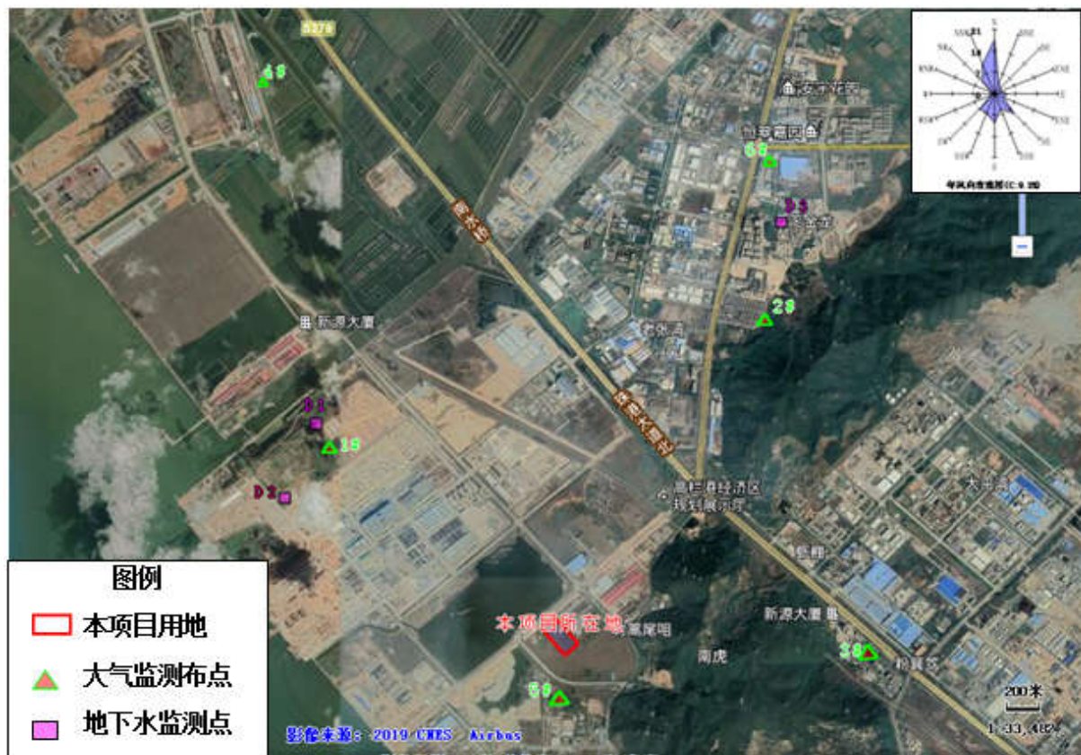
图 4.2-7 地下水监测布点
