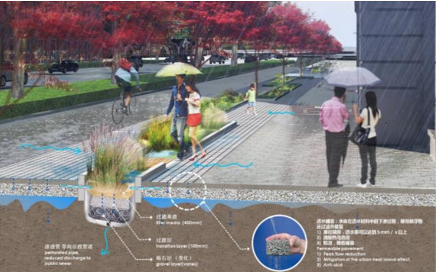
透水砖铺装典型结构示意图
